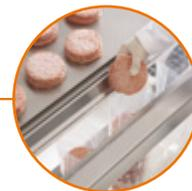
La zone de chargement d'1,5m dispose d'un passage produit de 150 mm
