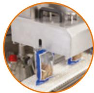
Bandes de soudure et doigts tendeurs synchronisés pour assurer des soudures de haute qualité
