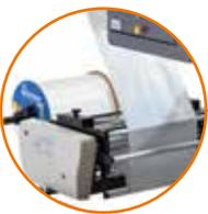
Dévidoir multi-position avec contrôle intégré de la tension du film
